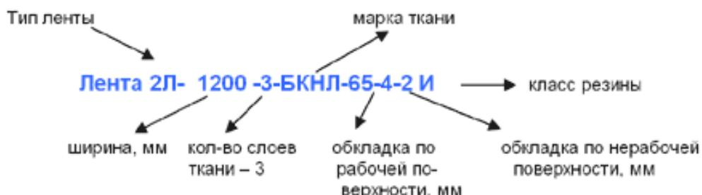
В зависимости от условий эксплуатации и назначения ленты изготавливают пяти типов:
